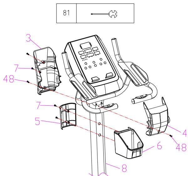
Соедините кожухи консоли (3 и 4) и зафиксируйте их при помощи винтов (7 и 48) на стойке консоли (8).
